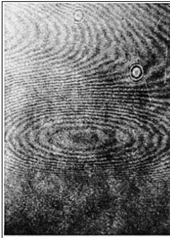
FIGURA 3.7 - Rede de difração que constitui um holograma de transmissão.
